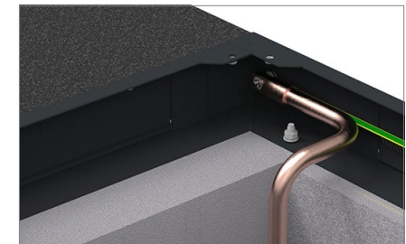
Abbildung 8: Anschrauben der Fundamenterdung an Erdungs-schraube im Sockel, Anordnung mit Sockelerde wie abgebildet.
