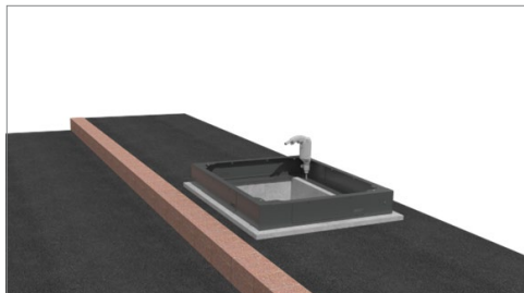
Abbildung: Bohren der Positionsbohrungen für Betonanker M10 mit Sockel als Lehre.
